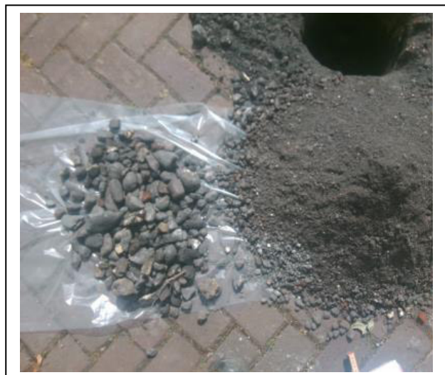
Foto 18. Asbestinspectiegat C01 25-50 cm-mv
