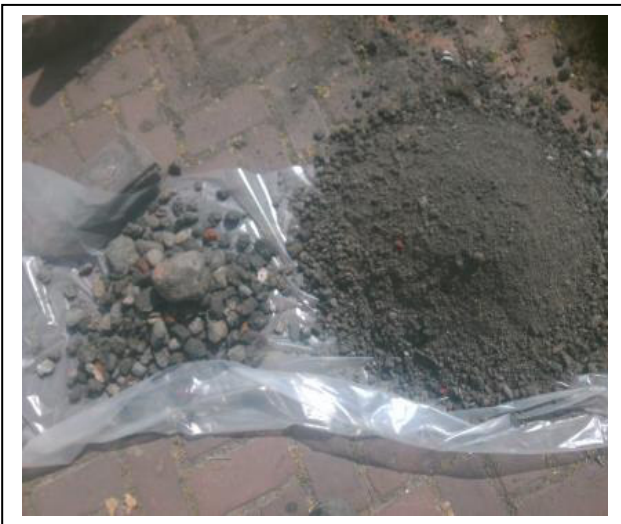
Foto 21. Asbestinspectiegat C05 30-50 cm-mv
